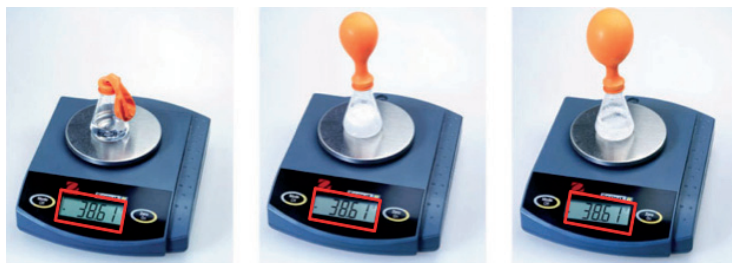
2. A lufiban szódabikarbóna van, a lombikban ecet. Rendszerünk zártnak tekinthető. Ha beszorjuk a lombikba a szódabikarbónát, szén-dioxid-gáz, só és víz keletkezik, de a rendszer tömege nem változik
