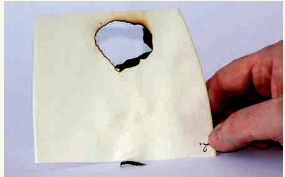
3. Izzó tű hatására a kálium-nitrátos rajz lassú izzással kiég
