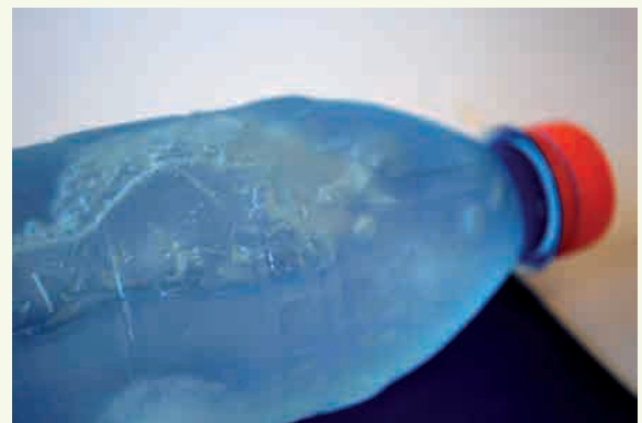
2. A fagyási folyamat a palack oldalától indul
