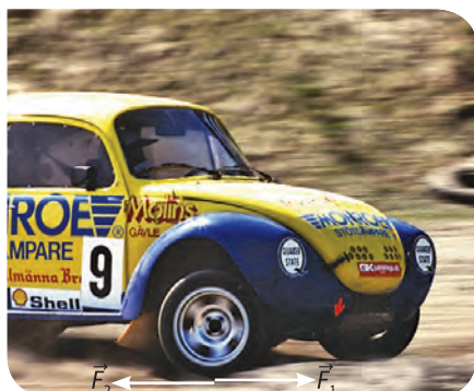
■ Az \vec{F}_2 erőt a talaj fejt ki a kerékre, az \vec{F}_1 erőt pedig a kerék a talajra. \vec{F}_1 = -\vec{F}_2
