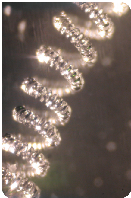
■ A hagyományos lámpa izzószála üzemi hőmérsékleten (kb. 2000 °C-on) fehéren izzik. Alacsonyabb hőmérsékleten vörösen izzik. Még alacsonyabb hőmérsékleten csak infravörös (nem látható) fényt bocsát ki.
