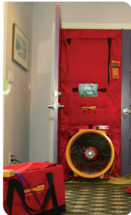
■ A Blower door teszthez használatos felszerelés
