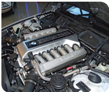
■ A BMW hidrogénnel is üzemelő gépkocsijának 12 hengeres motorja
