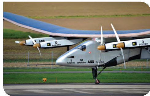
■ 2015-ben a Solar Impulse 2 napelemes repülőgép 16 óra alatt tett meg 1465 km-nyi távot
