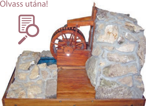
Felülcsapott vízkerék modellje
